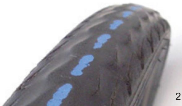
Afbeelding 98: Een band zonder profiel waarmee nog kan worden gereden (1), en een band met zichtbare anti-leklaag (2), die moet worden vervangen
