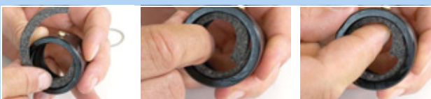
Afbeelding 159: Vilten ring inleggen
