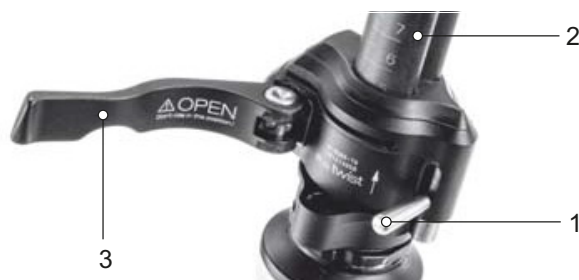
Afbeelding 85: Geopende spanhendel van de snelspanner (3) op de voorbouw (2), uitvoering I, met vergrendelhendel op de voorbouw (1)
