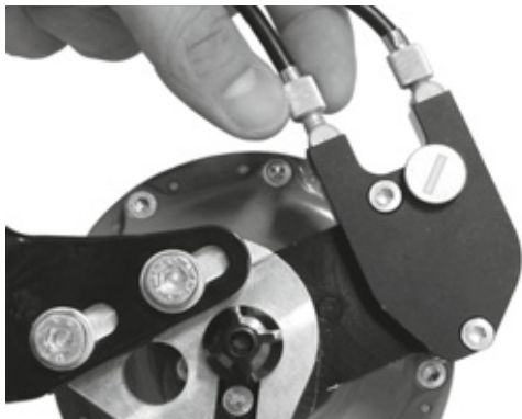
Afbeelding 104: Bij Rohloff naafversies met externe schakelaansturing zit de kabelafsteller op de kabelbox aan de linkerzijde
