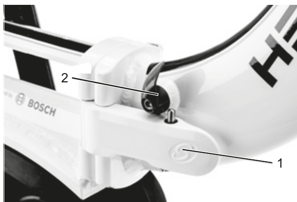
Afbeelding 87: Gesloten (1) en geopende (2) framevergrendelhendel
