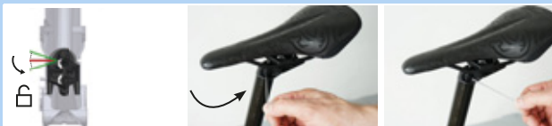
Afbeelding 111: Bediening hoogteverstelling in stand "geopend" zetten
